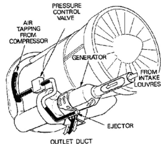
*Fig. 9. Generator cooling*
